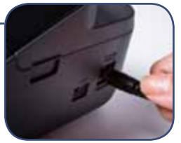
Toimii paristoilla (6 x AA) tai mukana toimitettavalla AC-verkkolaitteella
